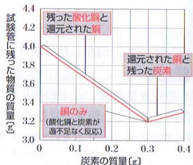
グラフの形が変化しているところに注目するんだ。このグラフでは炭素の質量が0.3gのところだよ。炭素0.3gを入れたときに試験管に残った物質が3.2gとなっているよね。このときに酸化銅と炭素が過不足なく反応しているんだ。つまり、4.0gの酸化銅に0.3gの炭素を入れて還元すると3.2gの銅が取り出されるんだよ。
