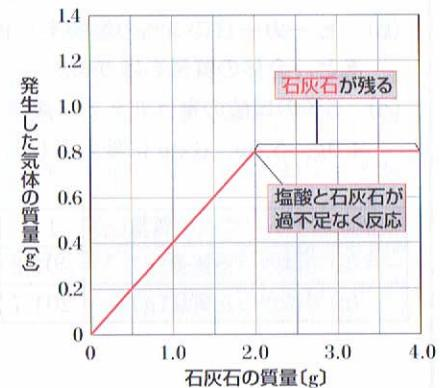
この実験で発生した気体は、二酸化炭素だ。ここでのポイントは、過不足なく反応しているところを読み取ることだ。この実験では塩酸20cm<sup>3</sup>に石灰石2.0gを加えたとき過不足なく反応して、0.8gの二酸化炭素が発生しているんだ。
