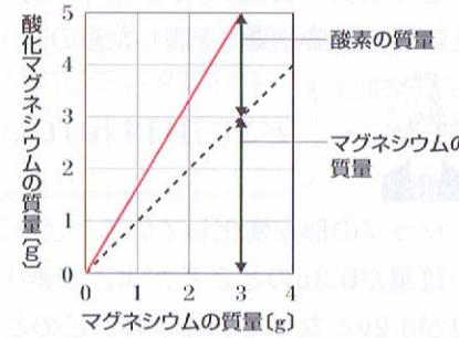
マグネシウムの質量が3gのときの酸化マグネシウムの質量は5gだよね。だから、3gのマグネシウムと化合する酸素の質量は $5g - 3g = 2g$ となるんだ。ここから、3gのマグネシウムは2gの酸素と化合して、5gの酸化マグネシウムができたことがわかるんだ。
