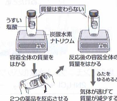
を反応させると二酸化炭素が発生する。このとき、密閉容器内で反応させると実験前後で質量の総和は変わらないが、ふたをゆるめると二酸化炭素が逃げていき、その分だけ軽くなるんだ。
